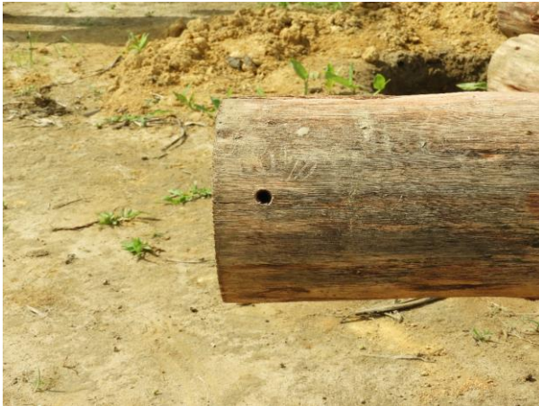
Figura 59 – Detalhe dos mourões furados
