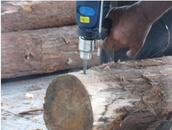
Figura 76 – Detalhe dos mourões furados
